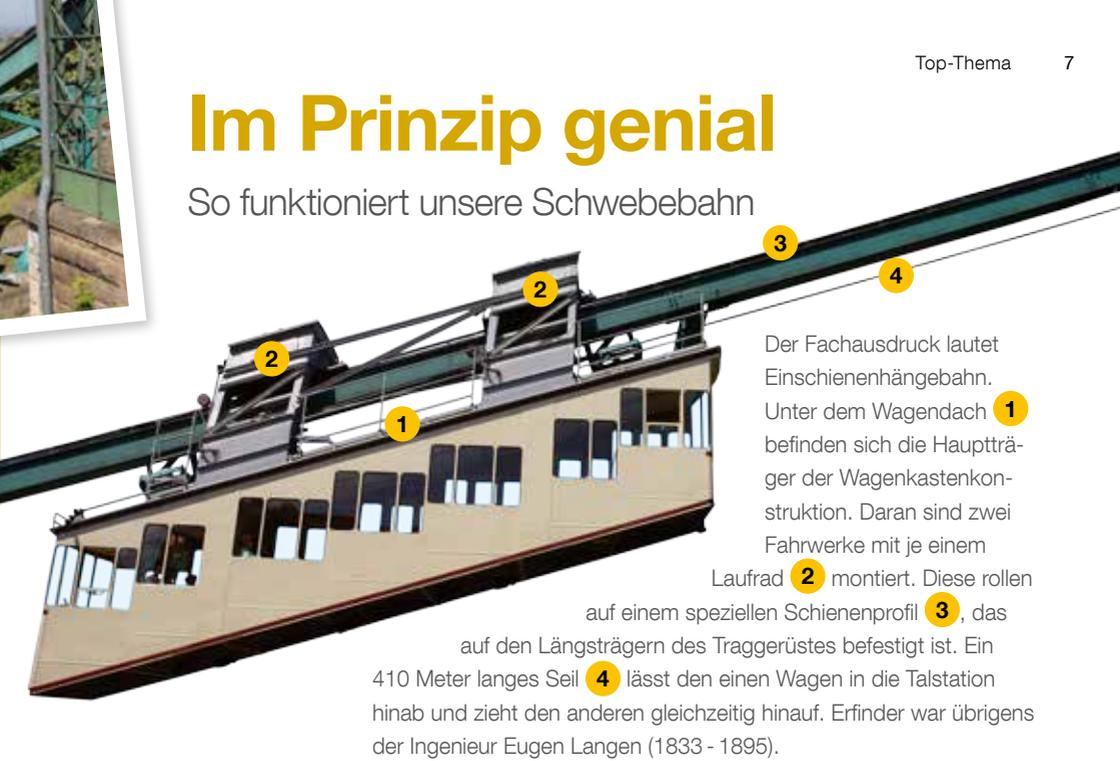
Der Fachausdruck lautet Einschienenhängebahn. Unter dem Wagendach **1** befinden sich die Hauptträger der Wagenkastenkonstruktion. Daran sind zwei Fahrwerke mit je einem
