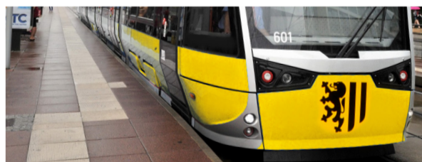
Erst oberhalb der Bahnsteigkante sollen die neuen Stadtbahnen breiter werden. So können bisherige und neue Wagen an den gleichen Stationen halten.
