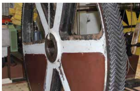
Nach 104 Betriebsjahren ausgetauscht: Das Großrad des Schwebebahnantriebs benötigt 190 speziell geformte Zähne
