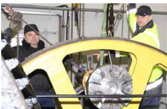
Holger Rohrbeck (li.) und Carsten Lauterbach bugsieren die geteilte Antriebswelle, die das Rad mit den Treibscheiben verbindet.
