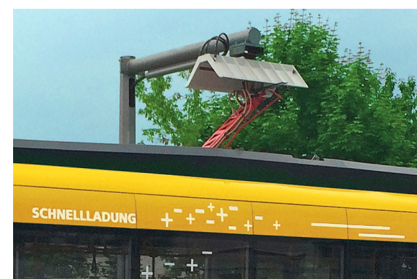
Etwa so soll die Nachladung des geplanten Elektrobusses für die Linie 79 in Mickten erfolgen. Der Stromabnehmer am Bus wird am Endpunkt nur für wenige Minuten ausgeklappt.
