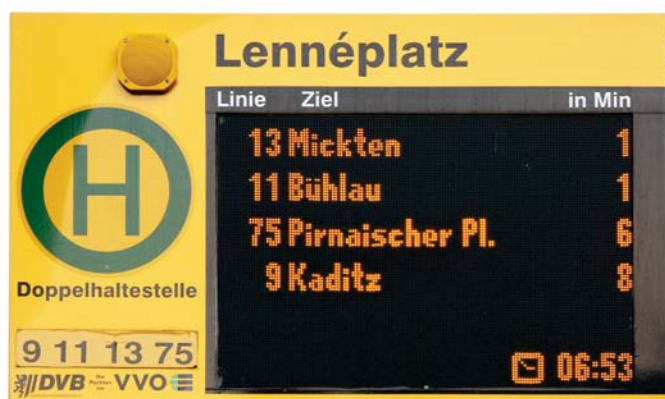
Die großen LED-Abfahrtstafeln sind auch über große Distanz gut erkennbar. Sie ersetzen an hochfrequentierten Haltestellen die veralteten Matrix-Anzeigen.
