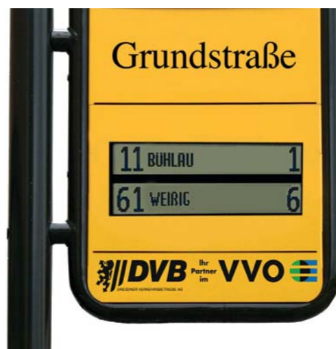
Ganz neu sind so genannte DFI-Light. Die LCD-Displays verbrauchen fast keine Energie. Sie sollen an Haltestellen eingebaut werden, an denen nicht so viele Fahrgäste einsteigen oder wo es kein Stromkabel gibt.
