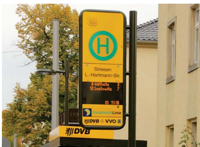
Direkt in die Haltestelle integrierte LED-Anzeigen sind die Variante für Stationen mit mittlerem Fahrgastaufkommen. Manchmal gibt es sogar zwei an einem Bahnsteig.
