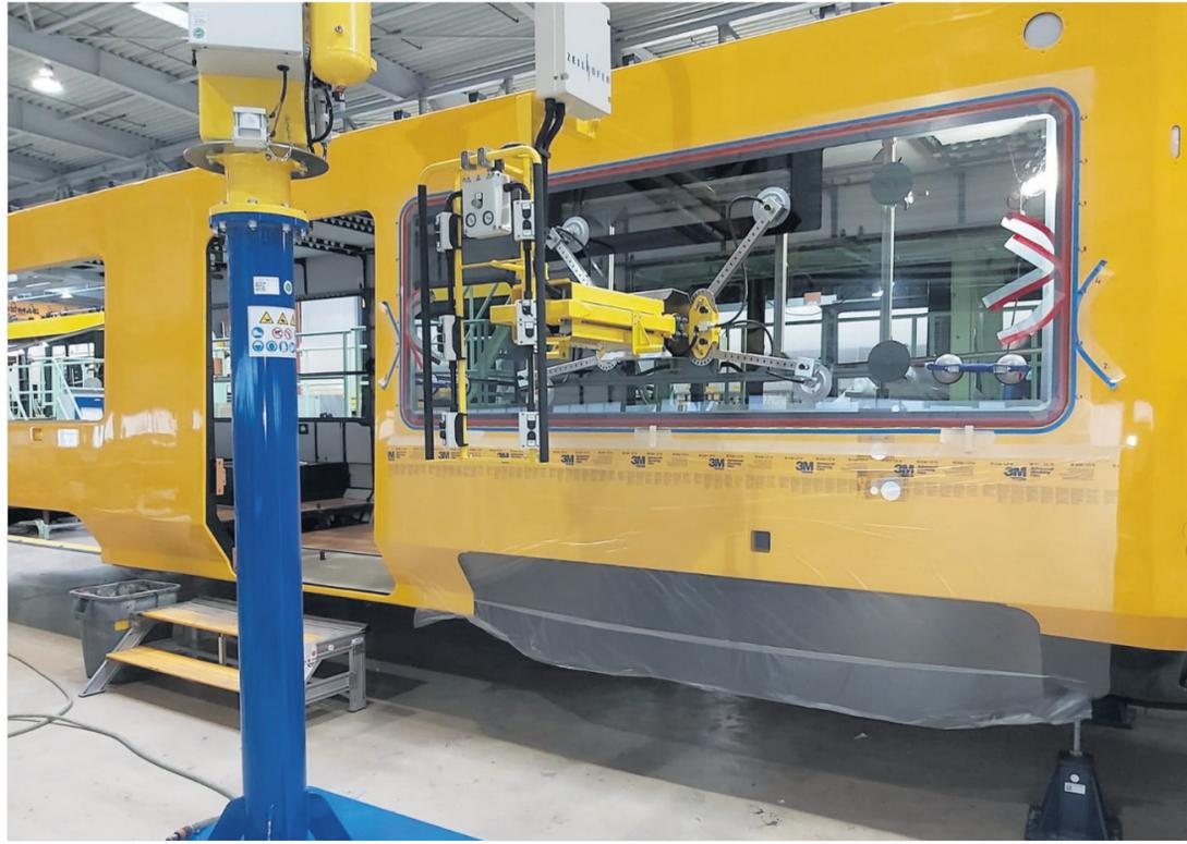
Der erste neue Stadtbahnwagen für Dresden hat bereits Fußböden und bekommt hier in Görlitz gerade die großen Panoramaischeiben. Im Schienenfahrzeugwerk Bautzen schließt sich die technische Ausrüstung und Endmontage an. Foto: Bombardier
