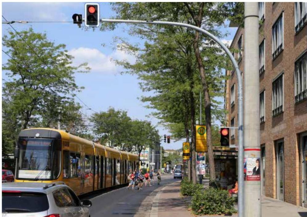
Solche Rotlicht-Ampeln schützen ein- und aussteigende Fahrgäste an Haltestellen. Sie werden nur aktiv, wenn eine Bahn in die Station einfährt.
