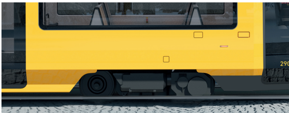
Durch die Drehgestelltechnik ist die Vis-à-Vis-Querbestuhlung erhöht.
