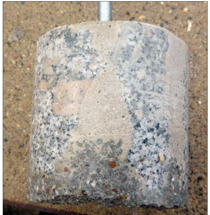
6. Bohrkern Pflastermonolith Aufnahme: DVB AG
