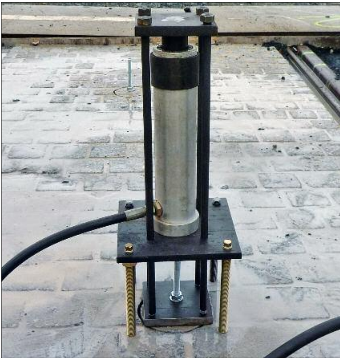
5. Gerät zum Aufbringen und Erfassen der Abreißkraft Aufnahme: DVB AG
