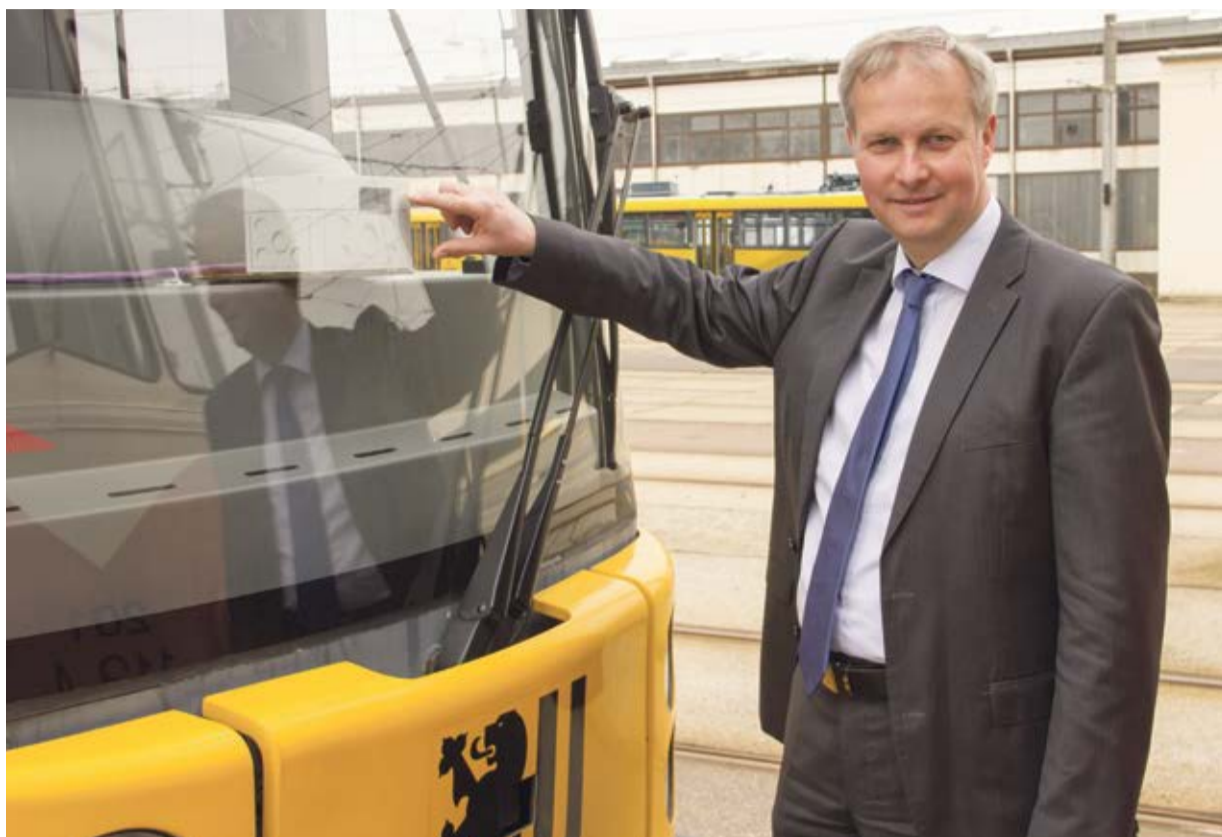
DVB-Straßenbahnchef Holger Seifert zeigt das Kameramodul hinter der Frontscheibe, das zur getesteten Kollisionswarneinrichtung gehört. Außerdem befindet sich in der Fahrzeugfront ein spezieller Infrarotsensor.
