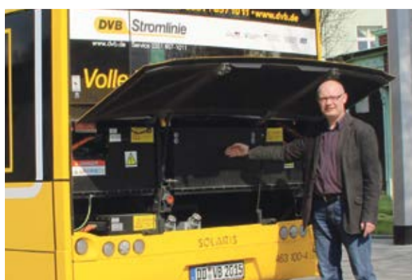
Der Leiter des DVB-Busbetriebes Robert Roch erklärt, dass zum sicheren Betrieb des Elektrobusse die Batteriemodule im Heck ausreichen. Die beiden Dachmodule können abgebaut werden
